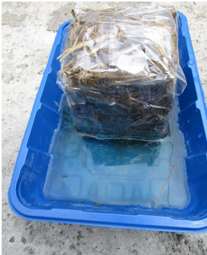
Figura 4. Proceso en el cual se sumerge una probeta en un molde con agua.
